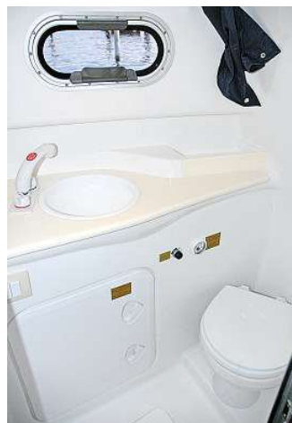
Knapp bemessene Nasszelle mit elektrischem Marine-WC
