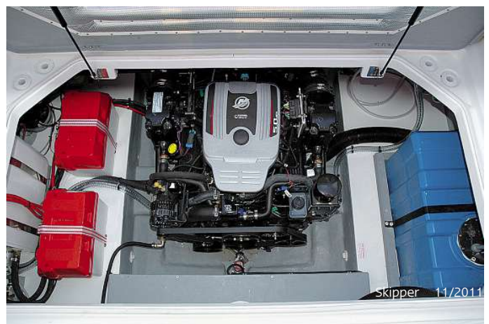
Klarer Pluspunkt: Die technischen Installationen im Maschinenraum wurden akkurat ausgeführt. Der MerCruiser leistet 191 kW
